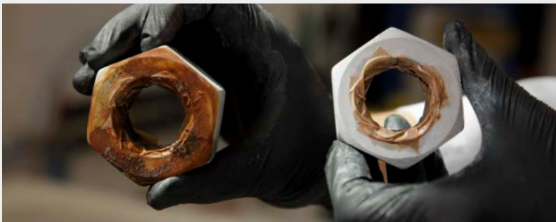
Ejemplo de dos piezas expuestas a corrosión en cámara salina, la de la izquierda sin protección y la de la derecha con Tecnadis Multicoat Anticorrosión
