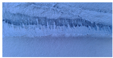
NO SE VE EN SUPERFICIE COSE POR DENTRO CON PERFECTA DISTRIBUCIÓN (MONOCAPA CON V13-MO POR FUERA Y POR DENTRO)
